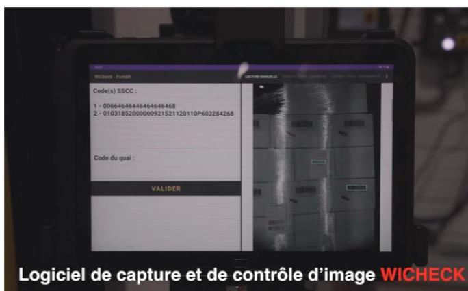
Le logiciel WICHECK permet de gérer l'ensemble des TOTEM. Il est installé sur une tablette Android. Vous pouvez suivre les lectures, visionner les images et gérer les alertes.
